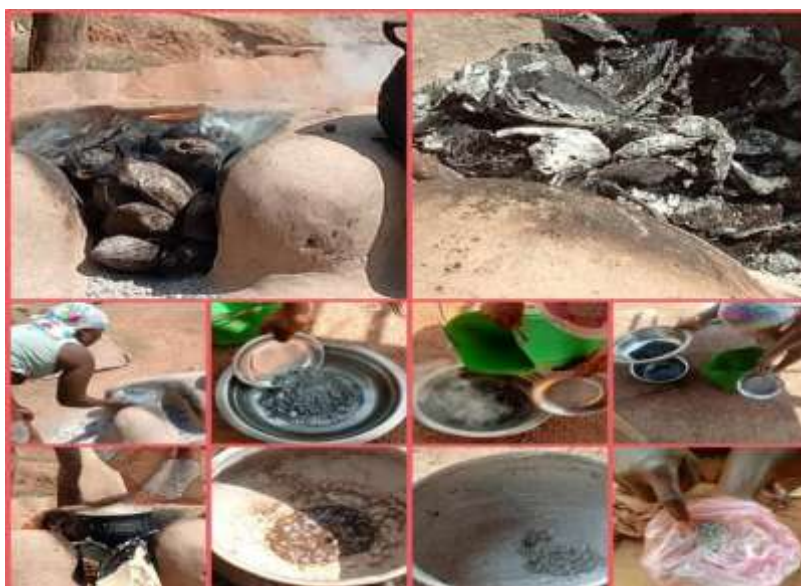
Photo 5: Processus de transformation de la coque de cacao en potasse
